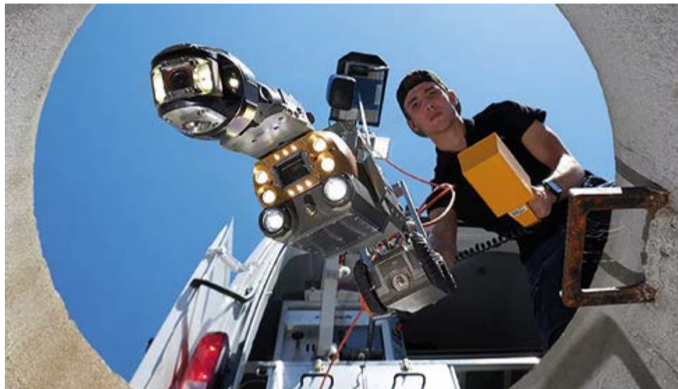
Mit technischem Know-how in die Zukunft: Umwelttechnologe leisten einen wichtigen Beitrag für den Schutz von Trinkwasser-, Boden-, und Gewässerqualität – zum Beispiel durch die regelmäßige Inspektion von Kanälen per Kameratechnik. (Bild: Rausch GmbH)
