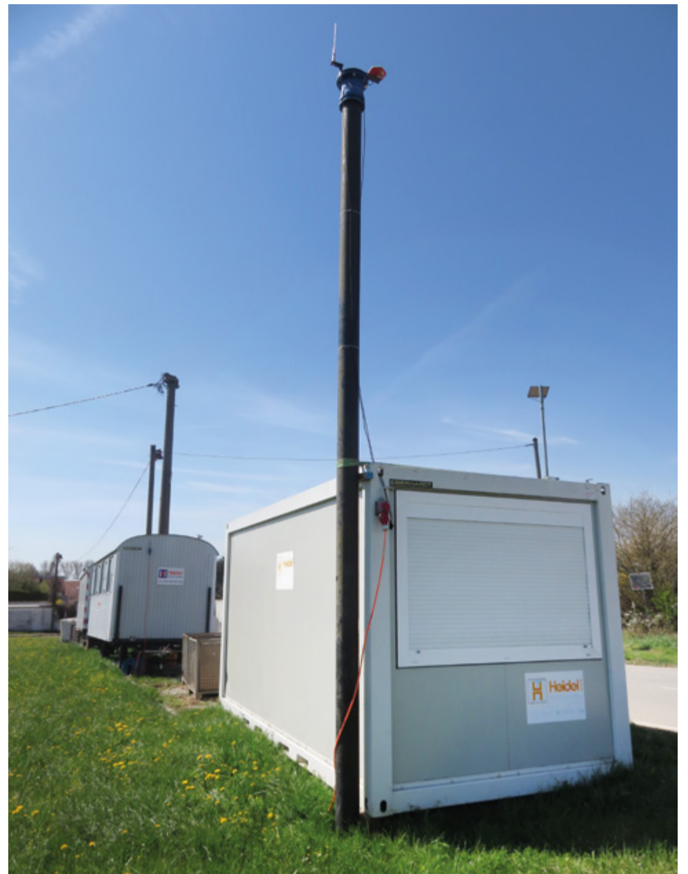
Wichtig für das Arbeiten mit BIM ist Funkkontakt. Hier die Basisstation mit GPS-Antenne.
