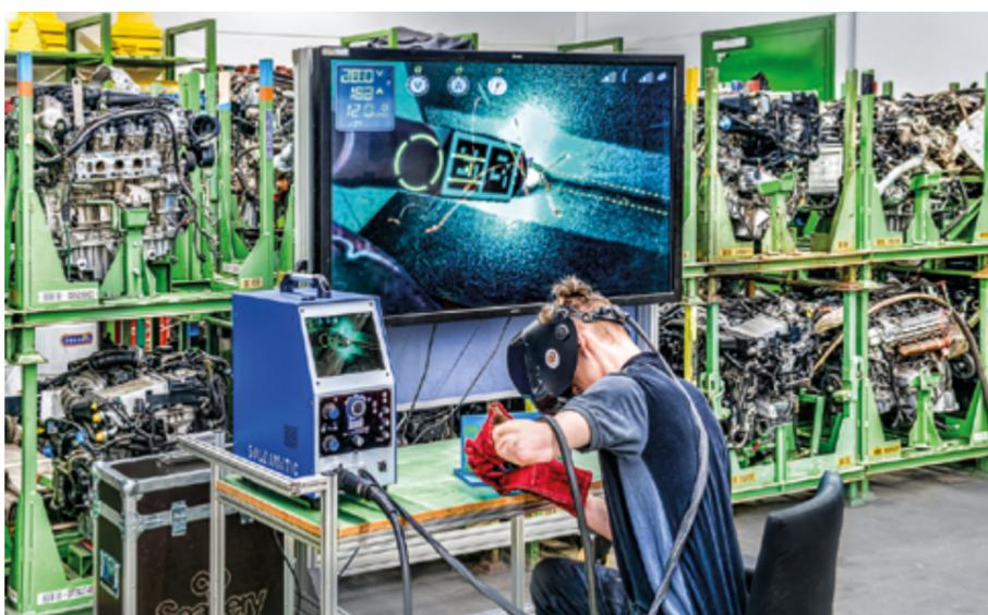
Bei dem Weiterbildungsformat Virtual Welding erlernen die Kursteilnehmer das Schweißen zunächst virtuell mittels VR-Brille. Sie gibt wichtige Informationen, zum Beispiel, ob der Brenner im korrekten Winkel zum Werkstoff gehalten wird und ob die Abstände korrekt sind. (Foto: WBS Training AG)
