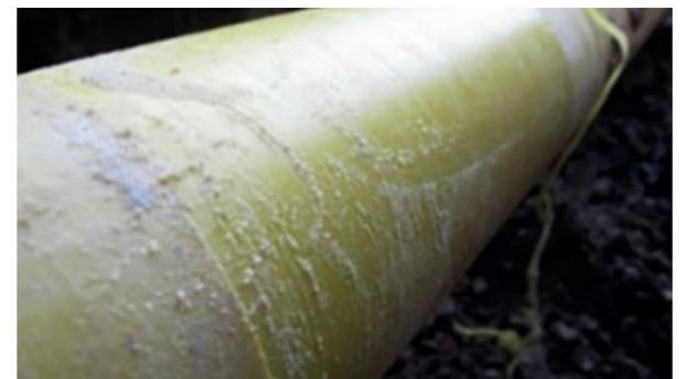
Die betroffenen gelben Gasrohre aus PE 80 zeigen einen weißen, spröden Belag auf der Rohroberfläche. (Foto: dvgw)
